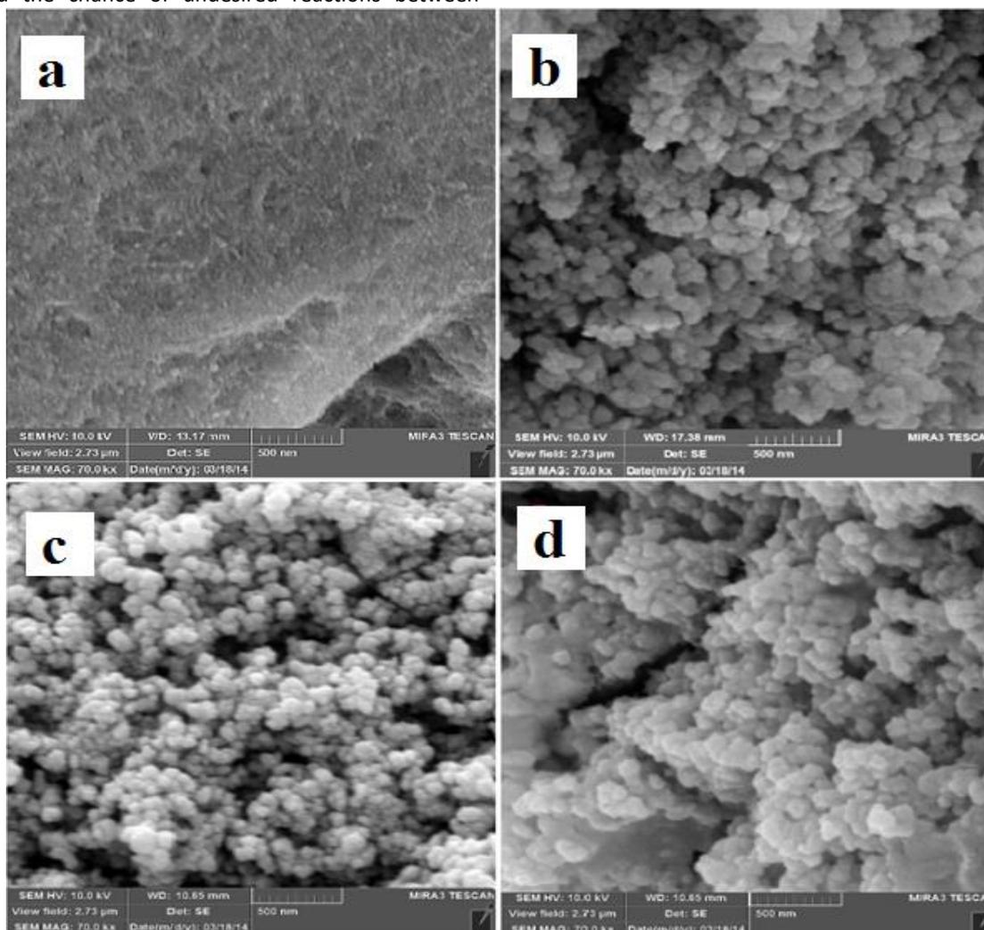
Fig. 3. SEM images of (a) Kissiris, (b) Kissiris/TiO<sub>2</sub>, and (c) Kissiris/TiO<sub>2</sub>/Fe<sub>3</sub>O<sub>4</sub>, (d) Kissiris/TiO<sub>2</sub>/Fe<sub>3</sub>O<sub>4</sub>/GOx.
